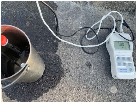
水質檢測 pH:7.8 DO:6.9mg/l EC:319µS/cm 水溫 28°C
